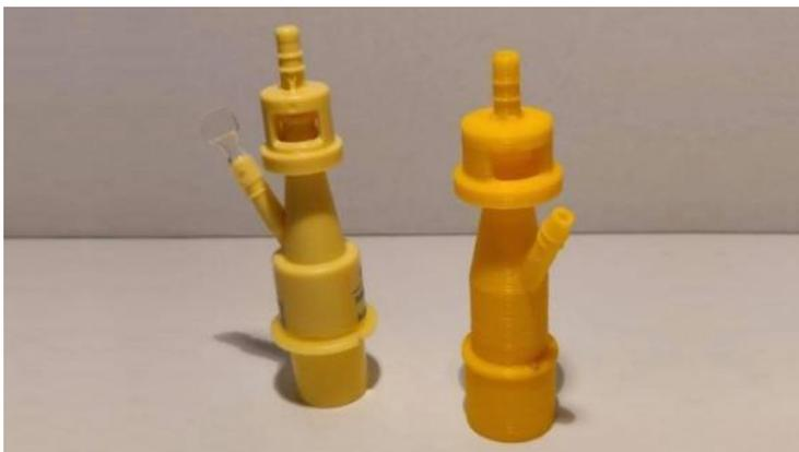
Abbildung 13: 3D-gedruckte Ventil von Isinova
